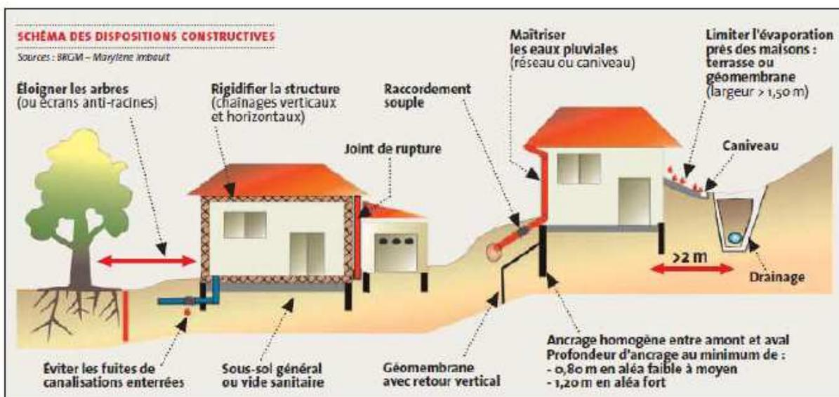
Illustration 5 : Schéma synthétique des dispositions constructives (www.georisques.gouv.fr)
